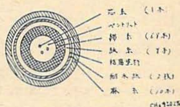
図 1. 導爆線構造図
