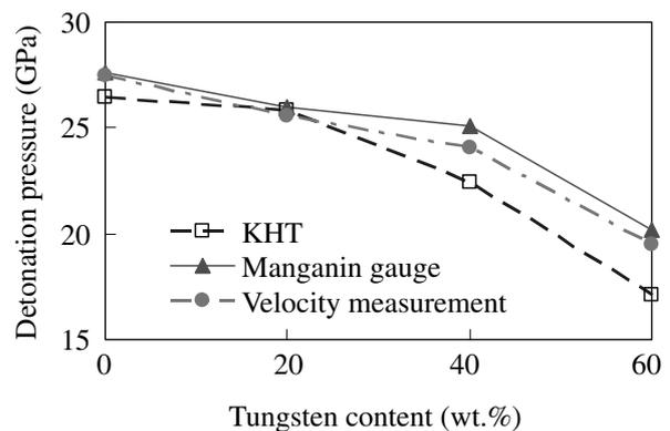
Fig. 4 Detonation pressure vs. tungsten content (wt. %).
