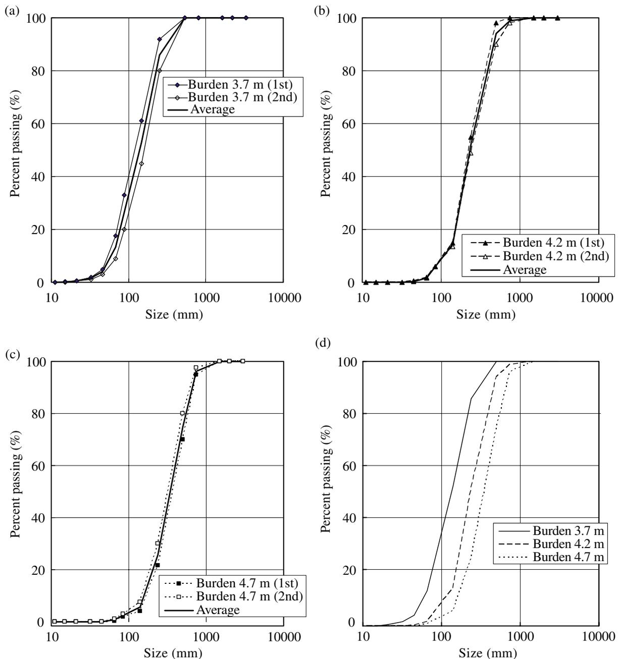
Fig. 8 Size distribution of the muckpile: (a) Burden 3.7 m; (b) Burden 4.2 m; (c) Burden 4.7 m; (d) All.
