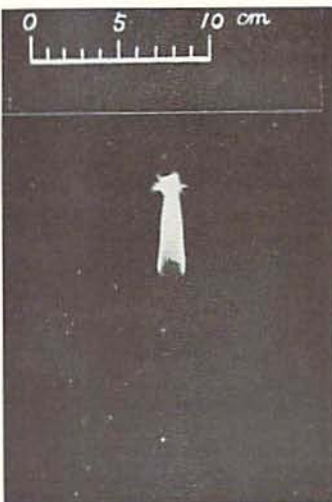
写真11 水酸化ナトリウム—硫黄—松炭の混和物，ニクロム線支持器使用，アルコールランプの焰の先端で灼熱したところ，小さい焰が火球表面より角状に出ている。 F 4.0，露出 \frac{1}{2} 秒。
