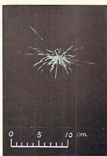
写真3 同左，反応後期で柳状火花を出しているところ。 F 4.0，露出 \frac{1}{2} 秒。
