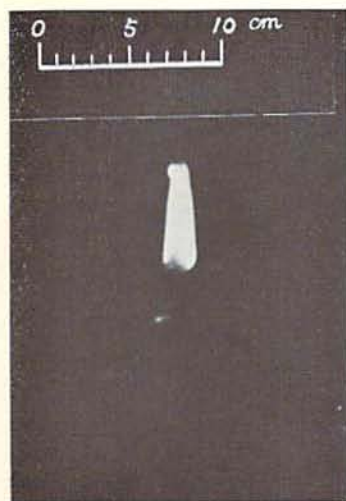
写真7 水酸化カリウム—硫黄—松炭の混和物，ニクロム線支持器使用，アルコールランプの焰の先端で灼熱してまさに火花を出そうとしているところ。 F 4.0，露出 \frac{1}{2} 秒。
