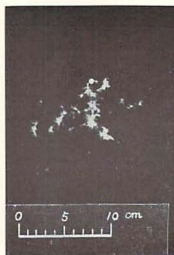
写真5 硝石-雄黄-松炭系，石英支持器使用，反応中期で盛んに松葉火花を出しているところ。 F 4.0，露出 \frac{1}{2} 秒。
