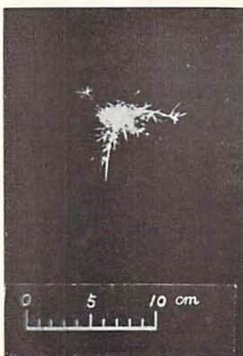
写真2 硝石-硫黄-松炭系，石英支持器使用，反応中期で盛んに松葉火花を出しているところ。 F 4.0，露出 \frac{1}{2} 秒。
