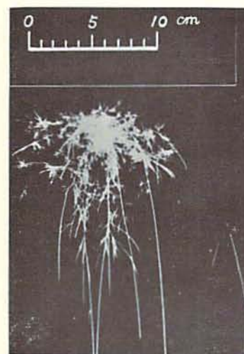
写真10 炭酸カリウム—硫黄—松炭の混和物，ニクロム線支持器使用，反応中期，松葉火花が盛んに出ているところ。 F 4.0，露出 \frac{1}{2} 秒。
