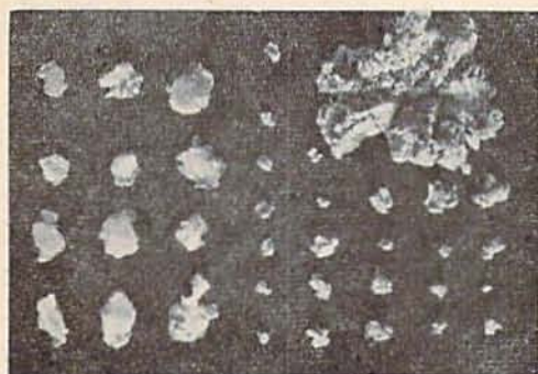
写真2 RDXによる鉛柱(Pb 99.18%)の破壊片の様相
