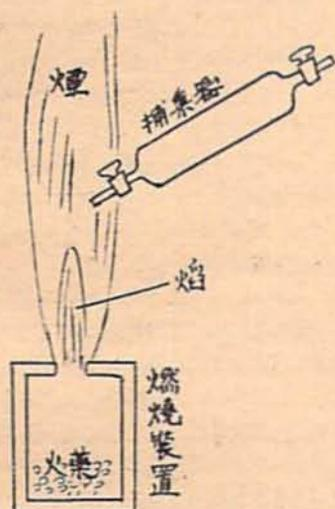
ス試験紙で存在を確認した。NO は捕集器に空気を入れると直ちに褐色となり、又デフェニルアミン、 $\alpha$ -ナフタルアミンの呈色反応で確認した。(CN)<sub>2</sub> 及び HCN は硝酸銀溶液にガスを通じて AgCN として認め又 Rhodes 法に依り HCN, (CN)<sub>2</sub> の分別定性試験を行つて両者の存在を明かにした。CH<sub>2</sub>=CH<sub>2</sub> は Ilasvay 法で第一銅塩溶液に通じてアセチライドの生成を検したが存在しなかつた。デニトロフェニルヒドラゾンの
