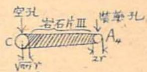
されて左方の空孔に向つて移動する。此の場合空孔Cの半径は装薬孔A<sub>1</sub>の半径より若干大であるから岩石片IIは固定岩壁よりの離脱が小心抜の時より容易である。又空孔が小心抜の時と異り1個しかない點以上の點を除いては先に小心抜に對して考察した式と類似の式が剪断距離 $y$ 又は $Y=y+(1+\sqrt{n+1})r$ に對して成立する。この場合 $y \ll r$ であるから $Y \approx y$ と見てよい。即ち
