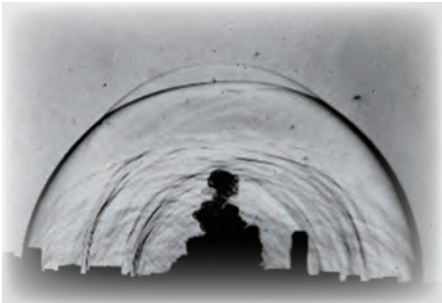
都市模型を伝播する衝撃波 (写真提供: 東北大流体研)
